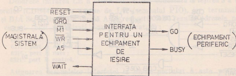
Fig. 8.12. Semnalele conectate la interfața.
